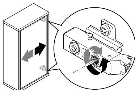
**Öffnungsmechanismus einstellen | Réglage du mécanisme d'ouverture | Regolazione del meccanismo di apertura | Adjusting the opening mechanism
